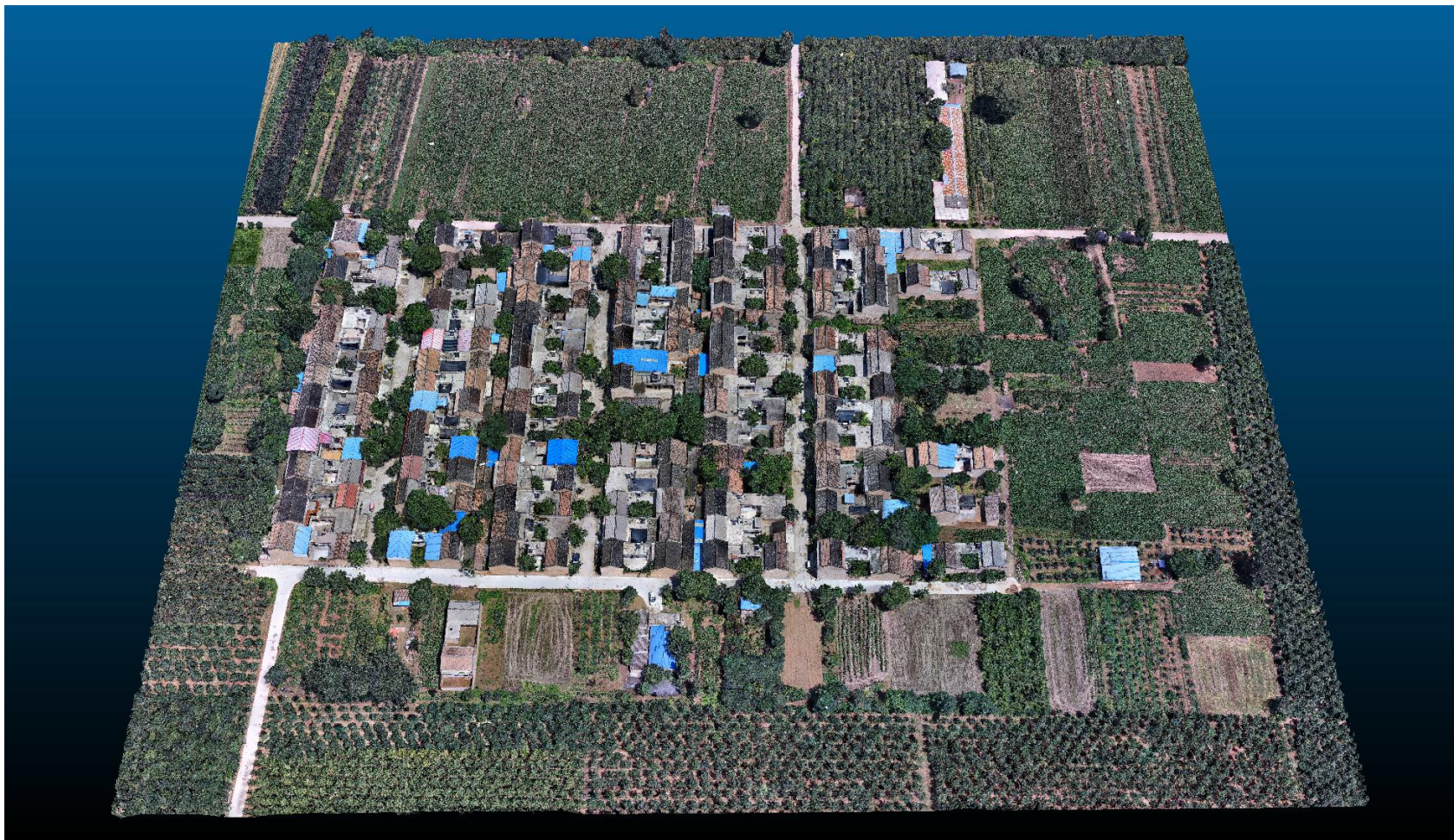
陕西省苏坊镇三维房地一体确权（倾斜摄影，4900幅图像）
