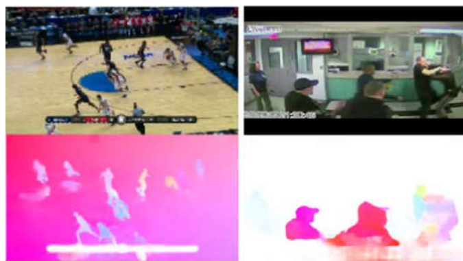
图 1 视频图像和光流场,不同的颜色(灰度)代表不同的运动方向(幅度),不同对象颜色和亮度不同,说明其运动关联性较小。左图:篮球视频中的光流场包含全局运动、局部运动的混合运动以及静态区域;右图:相机静止,光流场表达局部运动
