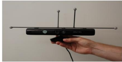
图 2 采集设备 KinectV1 (支架上带有球形的捕捉器标记)
