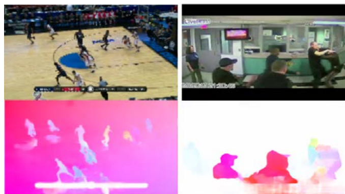
图 1 视频图像和光流场,不同的颜色(灰度)代表不同的运动方向(幅度),不同对象颜色和亮度不同,说明其运动关联性较小。左图:篮球视频中的光流场包含全局运动、局部运动的混合运动以及静态区域;右图:相机静止,光流场表达局部运动
